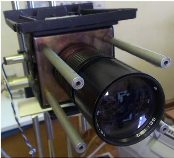
Рис. 3. Фото макета сканера
